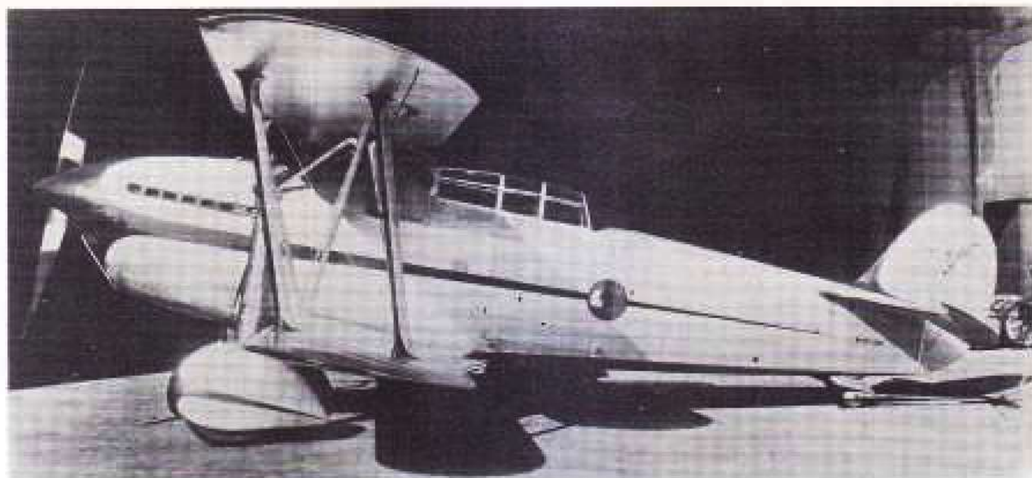
Il prototipo del Ro. 37 con motore Fiat A.30 e posto di pilotaggio chiuso da cappottina scorrevole
