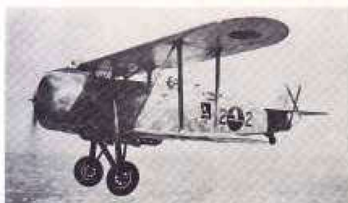
L'asportazione delle carenature alle ruote è praticata abitualmente per operare su terreni fangosi
