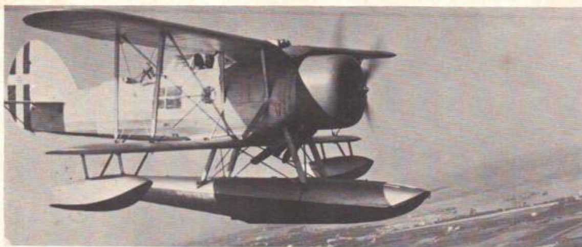
In questo Ro.43 è chiaramente apprezzabile la nuova configurazione del piano verticale di coda, a maggior superficie
