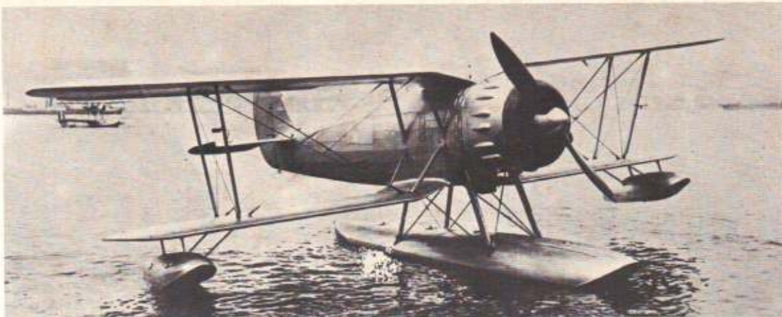
Il prototipo del Ro. 43 (MM.244) con motore Piaggio P.IX, cappottatura bugnata, elica bipala in legno ed ogiva. Inizialmente l'abitacolo è chiuso da cappottina scorrevole
