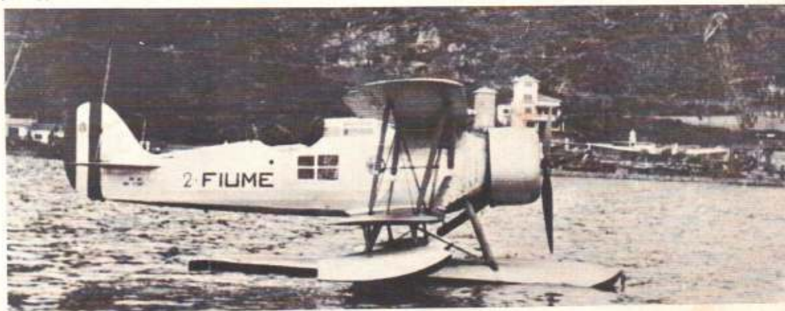
Ro.43 MM.27007 dell'incrociatore « Fiume »: l'elemento scorrevole di chiusura è ora limitato al solo posto di pilotaggio
