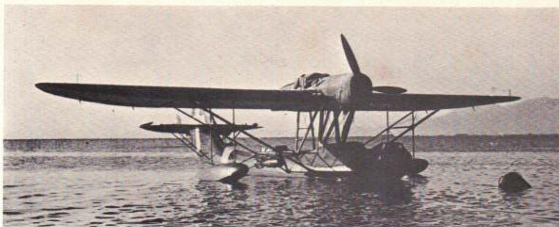
CZ.501 alla fonda: notare la disposizione del carico di caduta a mezza via tra fusoliera e galleggianti
